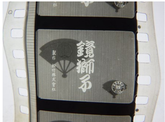
ビネガーシンドロームによる劣化で変形したフィルム
